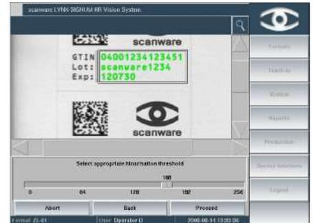
Le système de caméra OCR est totalement indépendant du format. Scanware a choisi un processus de reconnaissance basé sur les caractéristiques du caractère. Le système détecte automatiquement les positions de ces derniers.
