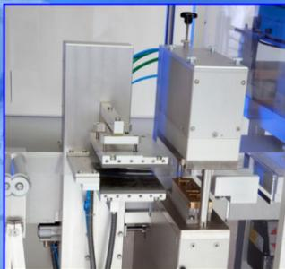
La station de formage standard peut travailler avec ou sans outillage de préformage ou en mode formage à froid. La profondeur de formage des alvéoles peut atteindre 40mm.
