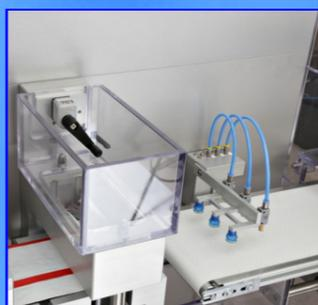
Conçu pour produire des formats de découpe entier, à coins arrondis ou en coupe droite, notre système de dépose blister piloté par servo moteur garantit une sélection fiable des mauvais blisters.
