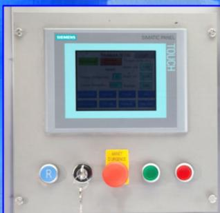
La machine est gérée par automate équipé d'un écran tactile pour un paramétrage aisé selon les besoins.
