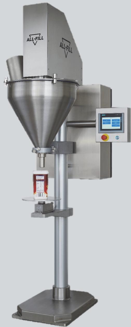
Le Doseur Pondéral des Séries 10 de All-Fill intègre une cellule de pesée ou balance, fournissant un signal de fin de remplissage, et supprimant ainsi les imprécisions de dosage causées par des produits de densité irrégulière.
