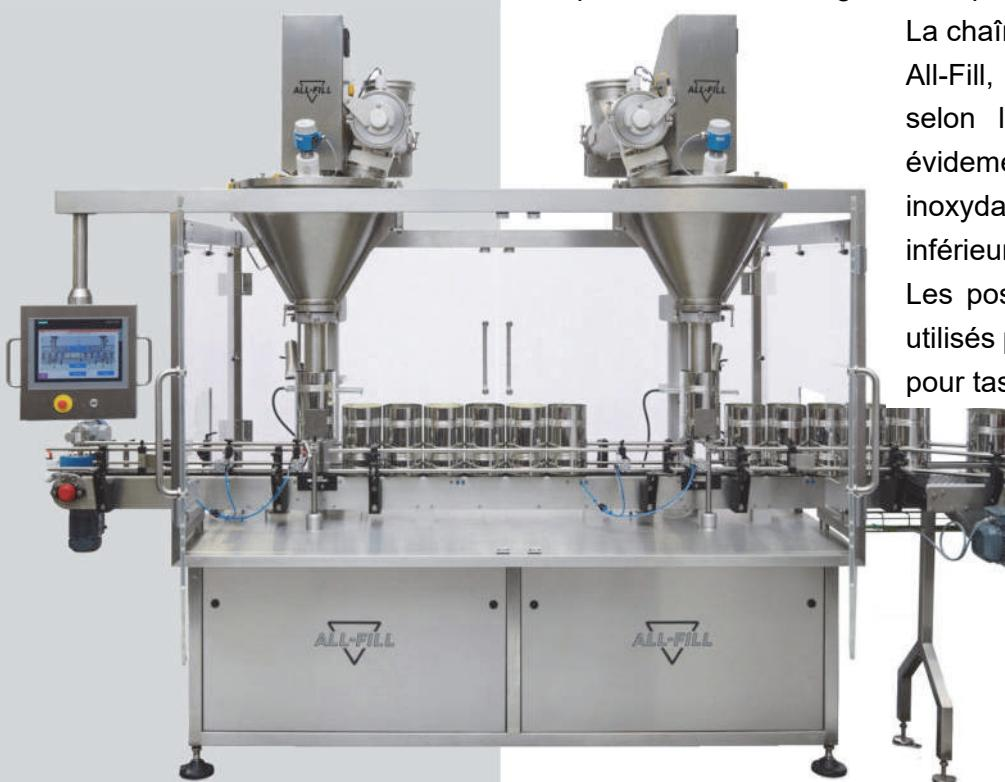
La chaîne de transport unique proposée par All-Fill, en acier inoxydable ou en plastique selon le cas, fournit une surface sans évidemment facilement nettoyable en acier inoxydable et facilite l'accès à la partie inférieure du contenant pour le soulever. Les positionneurs de goulets peuvent être utilisés pour centrer les flacons à col étroit et pour tasser par vibration, les produits
