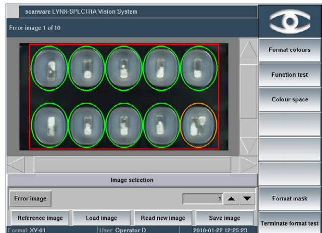
L'utilisation du mesurage x-y est indiquée pour différents types de produits dont les bandelettes médicales. Pour les capsules avec remplissage hétérogène, différentes positions du produit peuvent être analysées.
