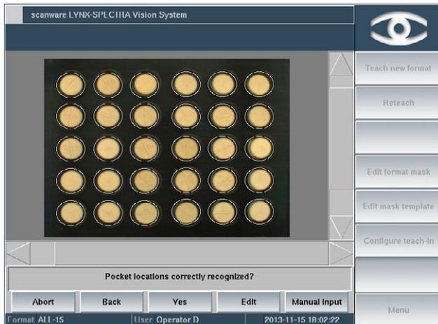
L'automatisation du processus d'apprentissage facilite ce dernier et permet de passer rapidement à la phase production. La position de l'objet, la géométrie du blister et la couleur du produit sont automatiquement détectées. Un apprentissage manuel est également possible.
