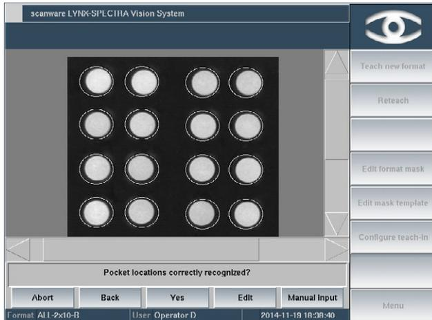
L'apprentissage offre une fonction de diagnostic automatique. Sur la base des images et des images d'erreur prises, le système définit une suggestion concrète de paramètres que l'utilisateur peut adapter si nécessaire.
