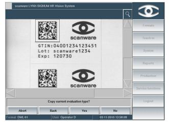
Fonction de copier le type d'analyse. Si le type d'analyse actuel, par exemple, une DataMatrix, est contrôlé à plusieurs endroits, il peut être copié. L'utilisateur entre le nombre de copies, le nombre de copies choisi est positionée par LYNX-SIGNUM HR. Marquant manuellement les types d'analyse omis.
