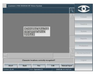
En mode OCR, le système détecte automatiquement les positions des caractères.
